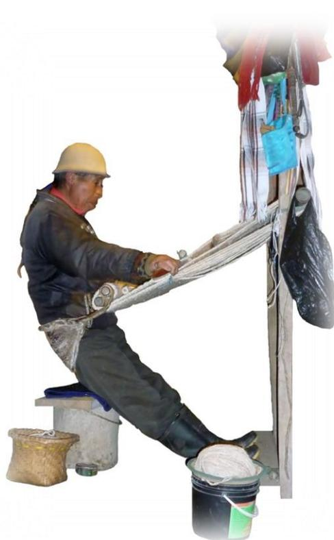
Se obtiene un **“banco o asiento”** estructura que consiste en una madera gruesa de 1.5m. de largo x 10cm. de ancho, donde se colocan los pilladores nombre con que se conoce a una madera de 60cm. de largo x 2cm. de ancho que son colocadas en cada extremo del banco a una distancia de 1m., para luego hacer en uno de los extremos a una distancia de 15 a 20cm. tres agujeros separados el uno del otro cada 5cm.
